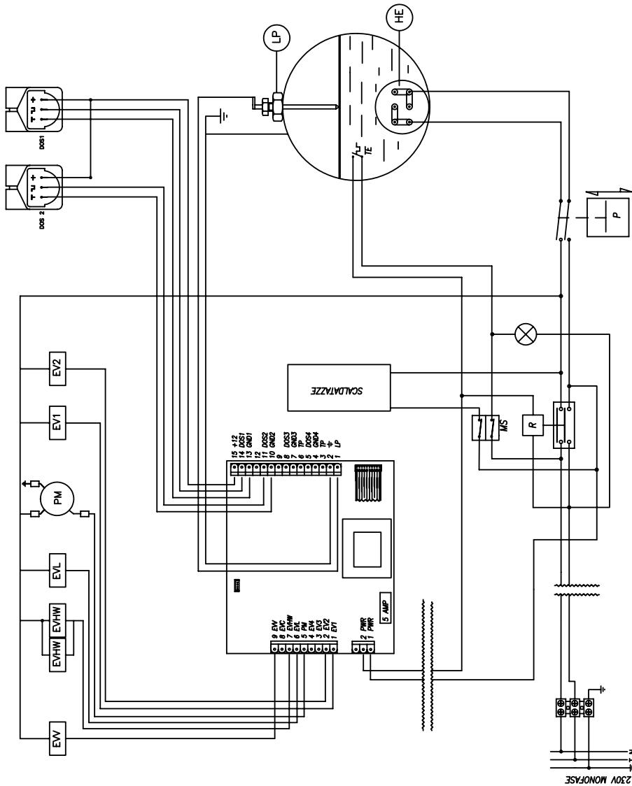
**IMPIANTO ELETTRICO / ELECTRICAL SYSTEM / INSTALLATION ELECTRIQUE**
